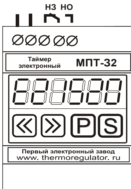
Рис. 1 Расположение контактов на клеммнике прибора.
